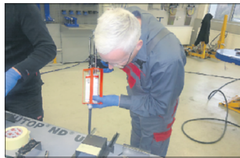
At lime pladedele kræver rene flader, korrekt limblanding og god tålmodighed.
