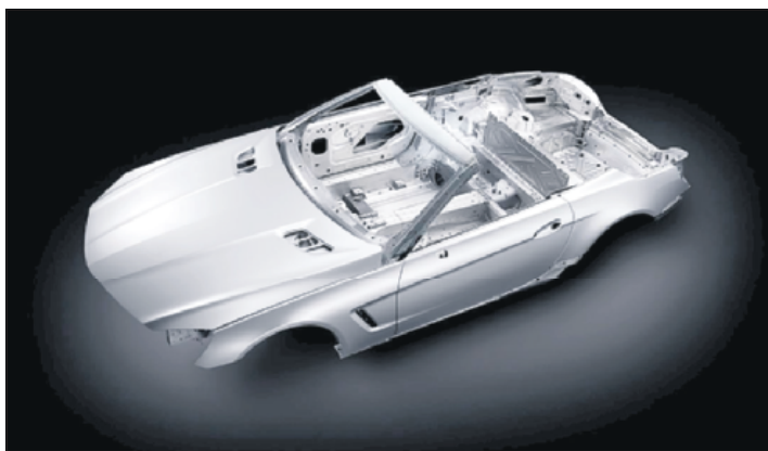
Det er vigtigt, at taksatorer og værksteder taler samme sprog og har samme viden om nye reparationsteknikker til de stadig mere avancerede karrosserier, mener SKAD – her den nye Mercedes SL som helaluminiums-base med magnesium og højstyrkestål i A-stolperne.
